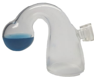
Obr. 1.1 Ukážka sklenenej banky dropcheckeru
